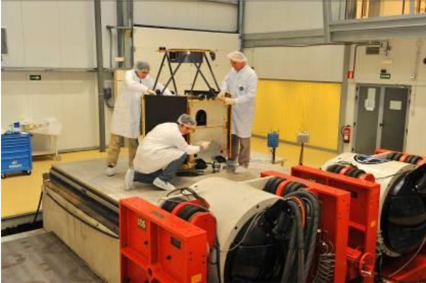
Ensaio de vibração nas instalações do INTA
